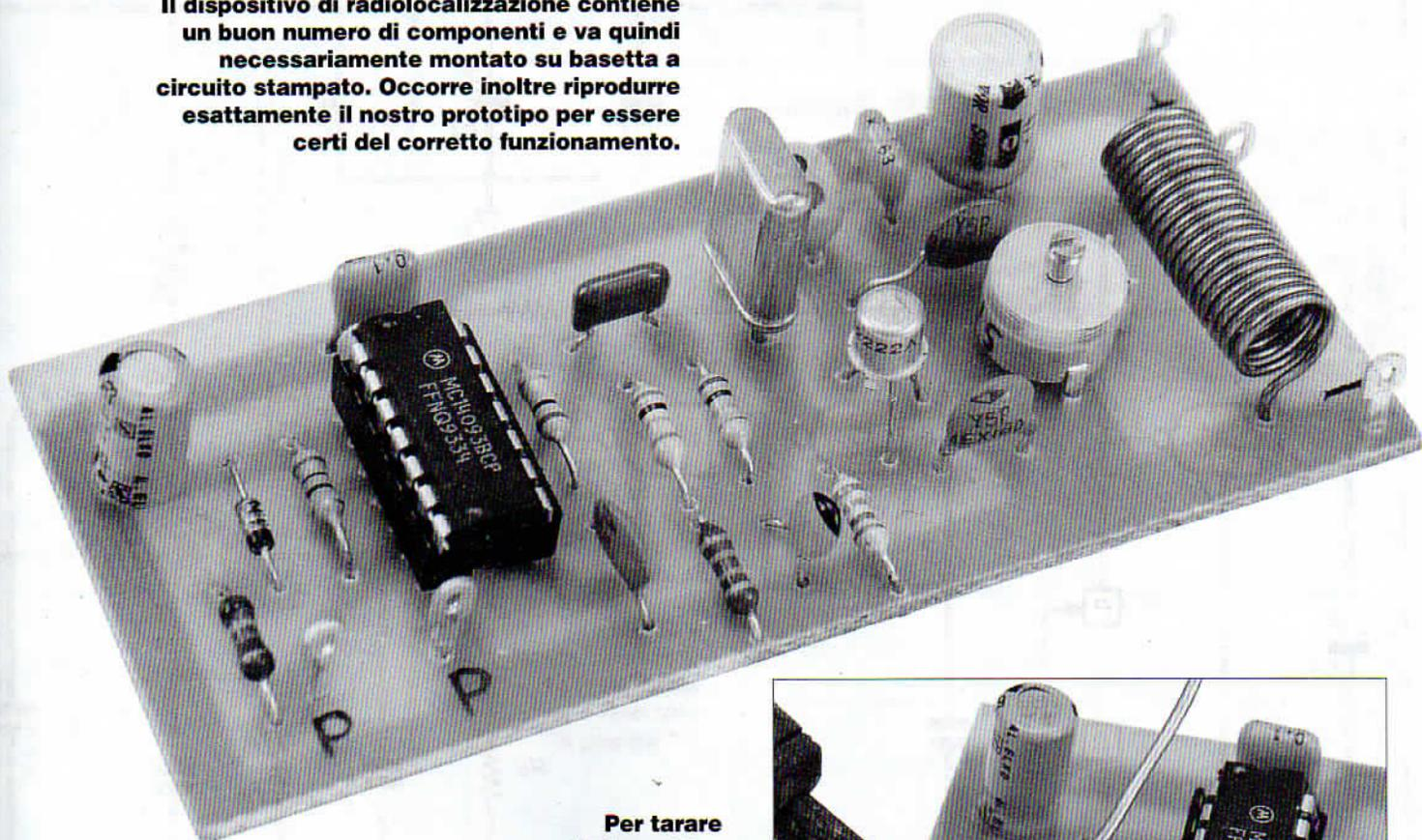
**Per tarare il dispositivo occorre fare un ponticello tra i due punti indicati con P: in queste condizioni il trasmettitore rimane sempre in funzione emettendo una nota continua utile per la taratura.**
