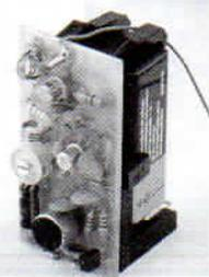
E' poco più grande di una normale batteria per radioline da 9V ! La sua sensibilità microfonica è molto elevata grazie all'impiego di una capsula microfonica amplificata. E' completo di filo antenna e portabatteria da 9V. Opera su frequenze comprese tra 88 e 108 MHz, ricevibili perciò con una normale radio FM. La sua portata è davvero
