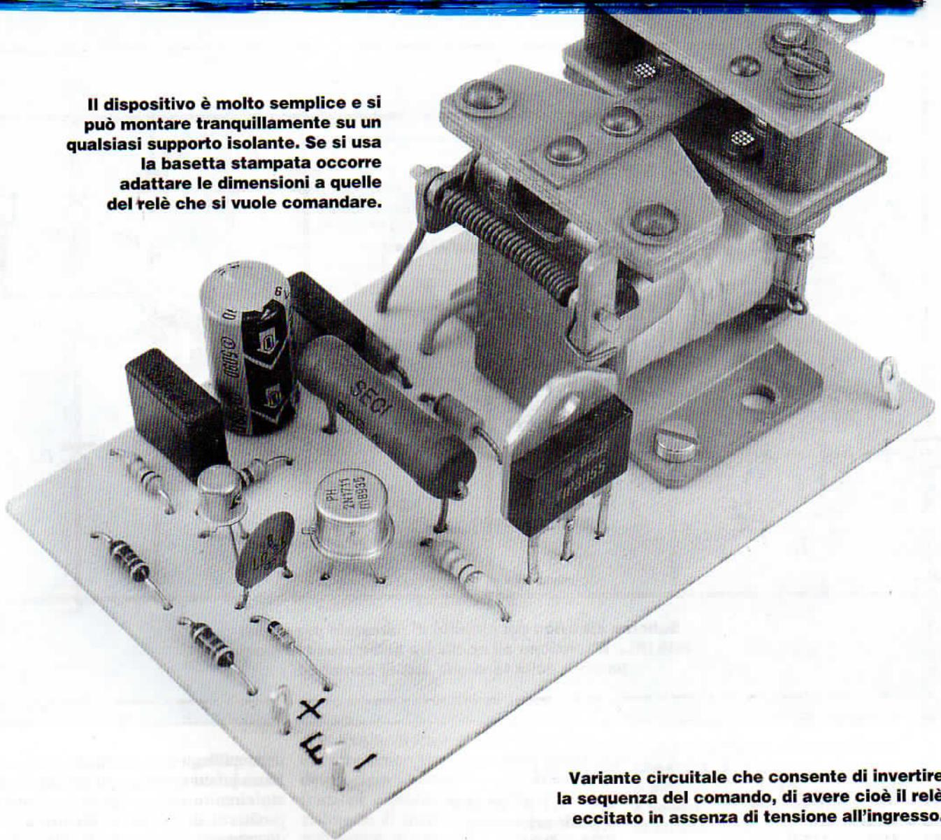
**Variante circuitale che consente di invertire la sequenza del comando, di avere cioè il relè eccitato in assenza di tensione all'ingresso.**
