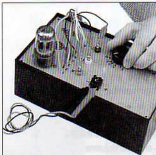
Il provavalvole è in grado di rilevare la funzionalità di alcune tra le valvole più comunemente reperibili sui banchi dei mercatini surplus. Lo strumento va collegato ad un tester che visualizza i dati.
