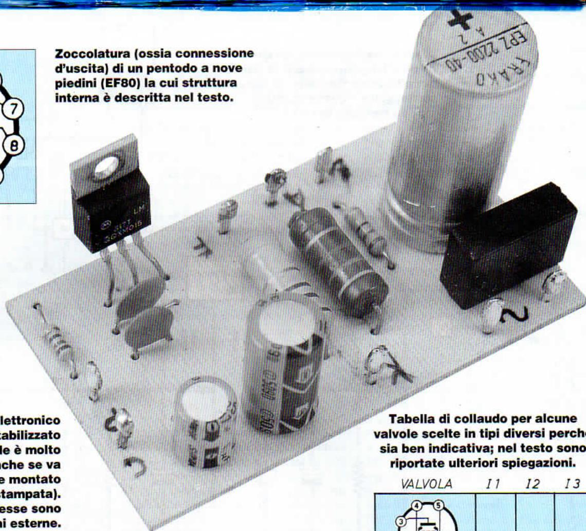
**Il circuito elettronico dell'alimentatore stabilizzato a tensione variabile è molto semplice (anche se va obbligatoriamente montato su basetta stampata). Più complesse sono le connessioni esterne.**
